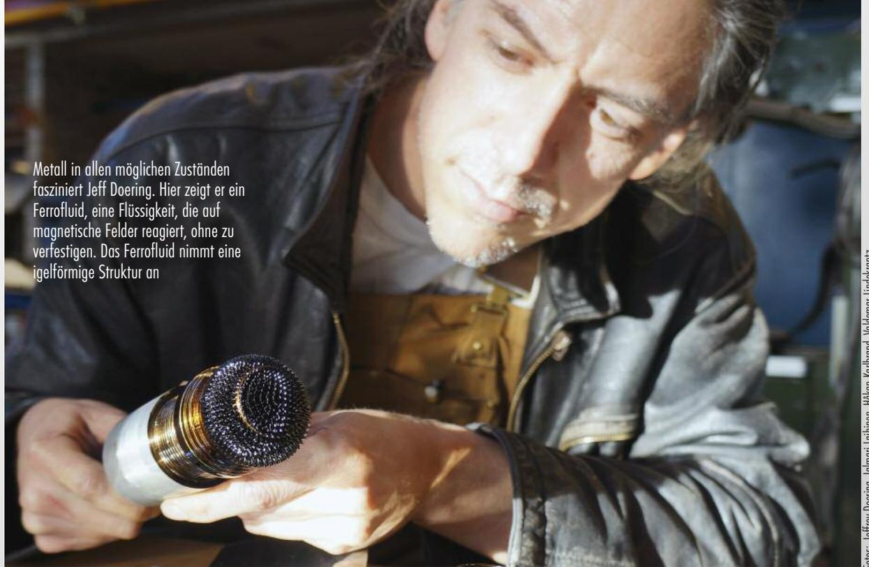
Metall in allen möglichen Zuständen fasziniert Jeff Doering. Hier zeigt er ein Ferrofluid, eine Flüssigkeit, die auf magnetische Felder reagiert, ohne zu verfestigen. Das Ferrofluid nimmt eine igelförmige Struktur an
